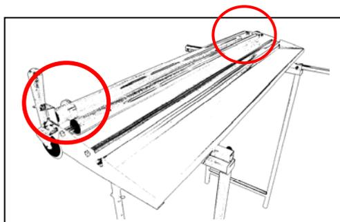
Die verstellbaren Ringe auf den Wellen (**roter Kreis**) auf die Rollenbreite der Folie einstellen. Dazu die Madenschrauben lösen, Folienrolle einfach zwischen den 2 Wellen einsetzen und die Ringe in Position schieben. Ein Ring rechts von der Folienrolle, den anderen Ring links von der Folienrolle positionieren, damit die Rolle sich horizontal nicht verschieben kann.
