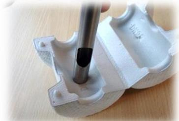
Mit der Lochpfeife oder mit angespitztem Rohrstück lassen sich (bei Bedarf) auch die Löcher für die Rohraustritte sowie den Spindelhalbs vergrößern.
