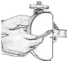
**3.** Liegt die Baulänge der Kappe fest, können die Öffnungen für den Rohraustritt in die Deckelhälften mit Hilfe einer Blechscher (IDEAL- oder Lochschere) geschnitten werden. Hierbei ist zunächst anhand **einer** Deckelhälfte, die man zur Armatur hält, zu prüfen, wie der Armaturenkörper in der Kappe zu liegen kommt.
