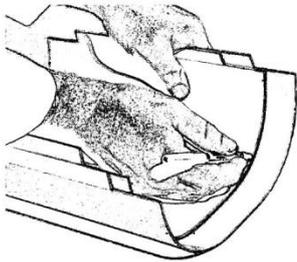
**1.** Zunächst wird der Kappenmantel an die notwendige Isolierlänge der Armatur angepasst. Diese Baulänge der Kappe hängt davon ab, ob und wie weit die Kappe die angrenzende Rohrisolierung überlappen soll. Mit Hilfe einer stabilen Schere (besser: Blechscher) kann der Kunststoff-Kappenmantel nach Bedarf gekürzt werden, wobei
